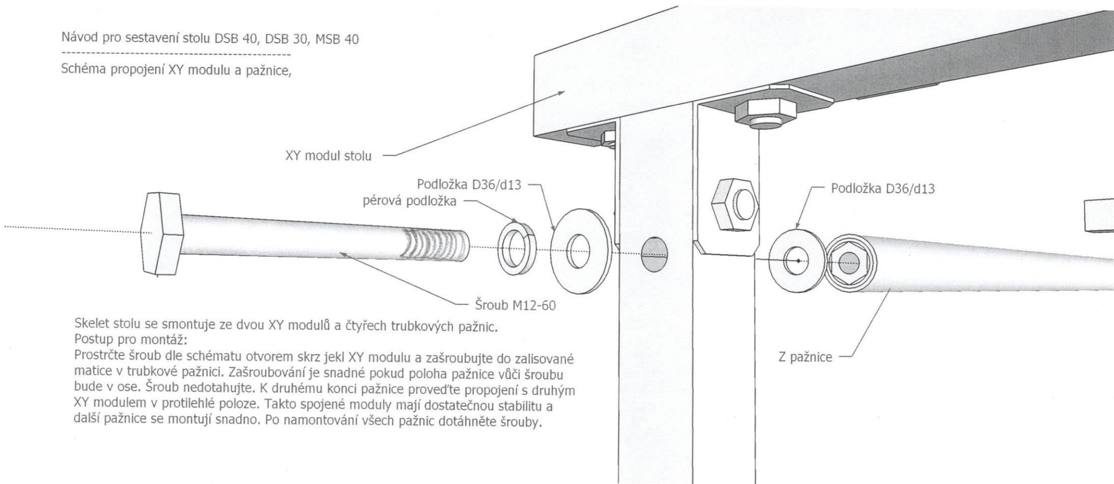
Skelet stolu se smontuje ze dvou XY modulů a čtyřech trubkových pažnic.
