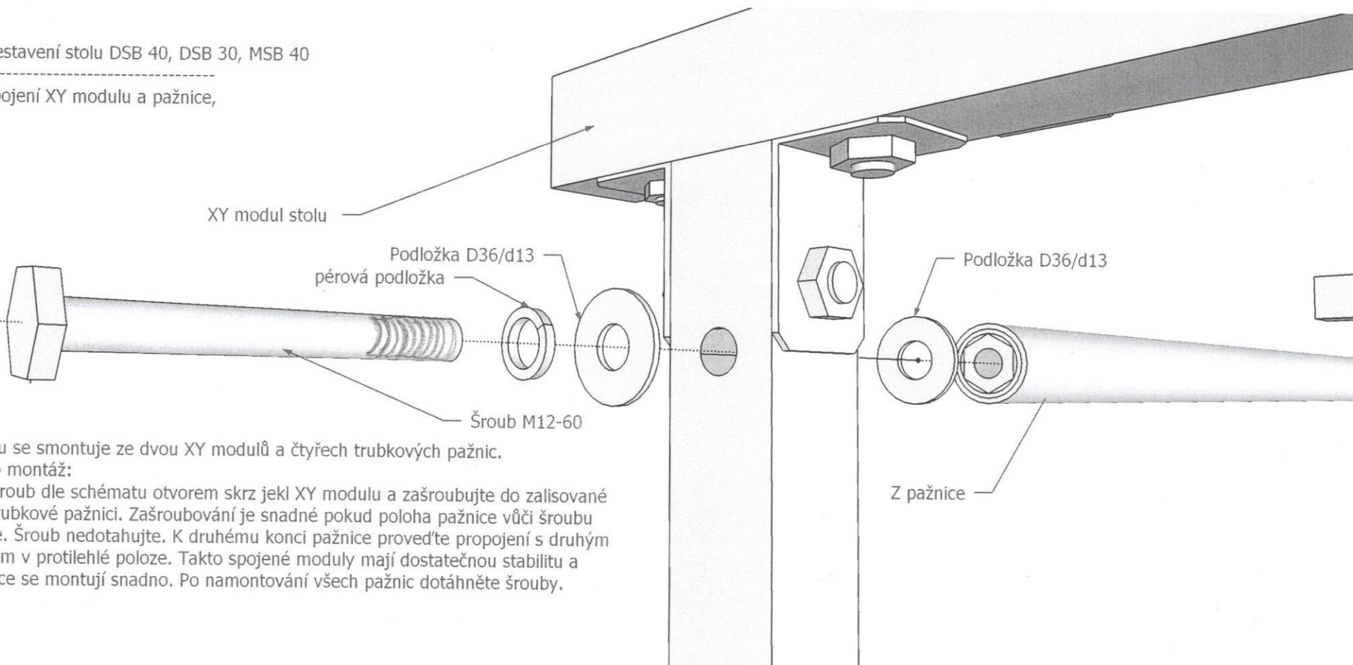
Skelet stolu se smontuje ze dvou XY modulů a čtyřech trubkových pažnic.
