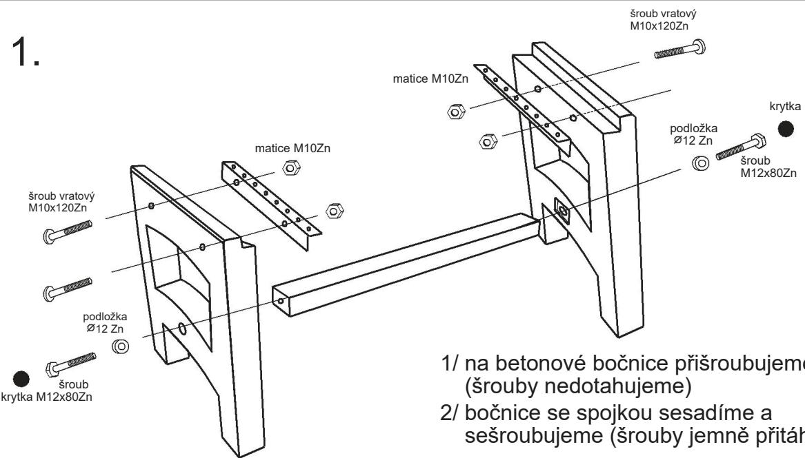
1/ na betonové bočnice přišroubujeme kování (šrouby nedotahujeme)
